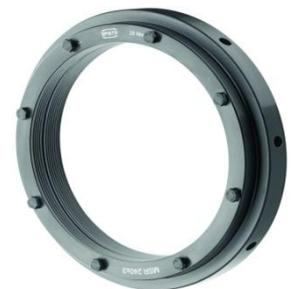
Für die zulässige statische Axiallast wird die Streckgrenze des Materials mit einer Nutzsicherheit von 1,6 herangezogen. Sie gilt für ein Wellengewinde mit der Toleranz 6g oder genauer sowie mit einer Mindestfestigkeit von 700 N/mm<sup>2</sup>. Bei dynamischer Belastung sind ca. 75% der statischen Axiallast  $F_{ax,stat}$  zulässig.
